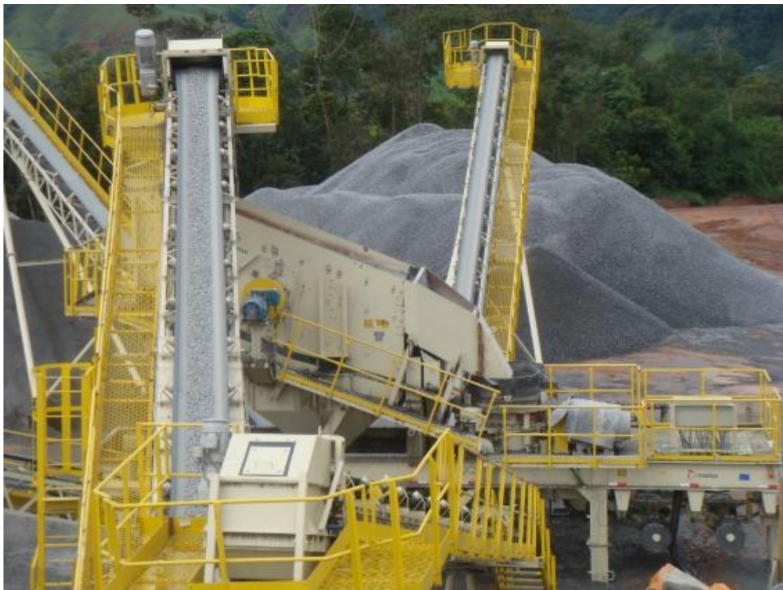
Foto 9: Peneira vibratória com 3 decks e britador secundário cônico.
